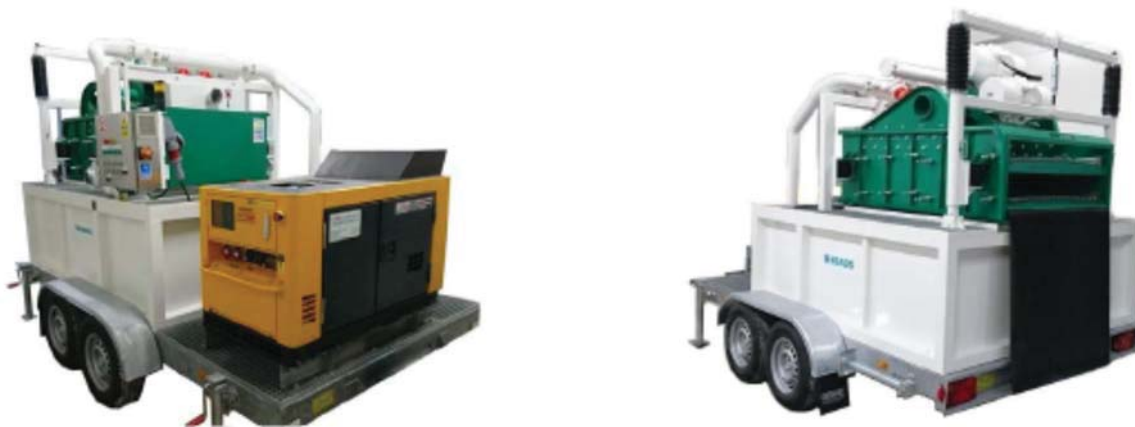
Рисунок 9.3 – Трехступенчатая перерабатывающая установка производительностью 300–500 л/мин на колесной паре
