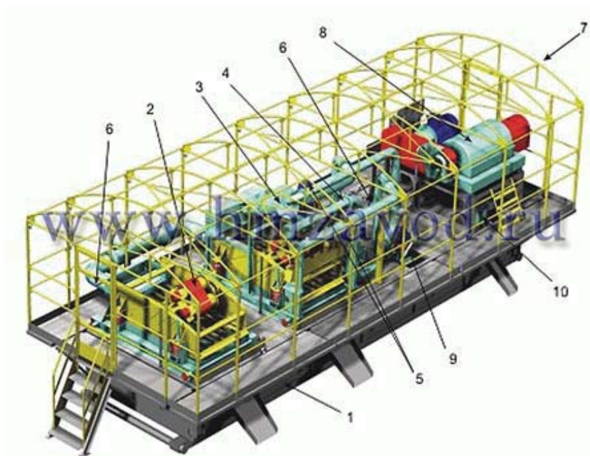
1 – емкость; 2 – вибросито; 3 – пескоотделитель гидроциклонный;
